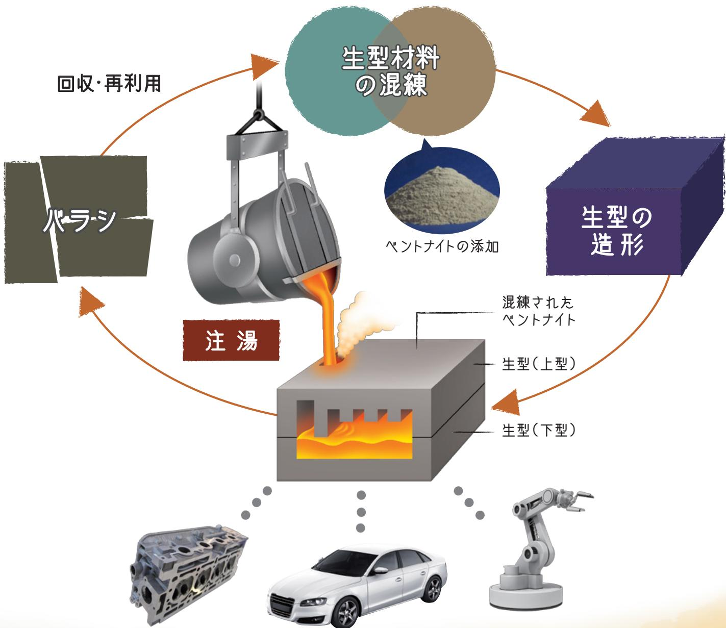
加熱して溶かした金属を型に流し込み、冷えて固まったものを型から取り出して作った金属製品「铸物」。日用品・美術品から自動車や工作機械の部品まで、私たちの生活をあらゆる方面で支えている、铸物づくりになくてはならない材料がペントナイトです。
